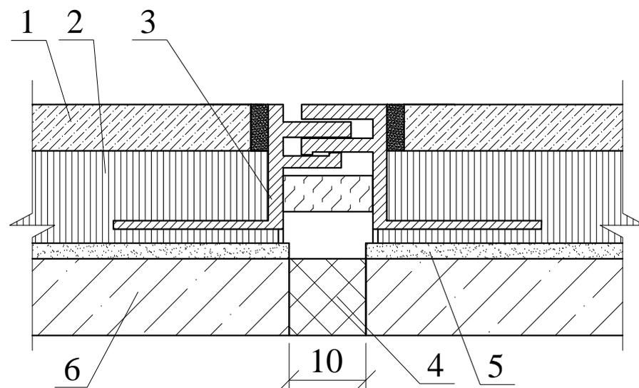
1 - керамическая или керамогранитная плитка; 2 - клей под плитку; 3 - алюминиевые направляющие элемента деформационного шва ДШ-ПЛЗ; 4 - наполнитель деформационного шва из пенополистирола; 5 - выравнивающая стяжка из цементно-песчаного раствора; 6 - железобетонная плита перекрытия
