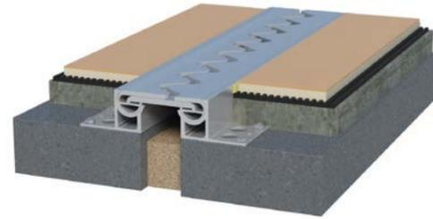
Деформационные профили ДШ-ЗУП под очень высокие нагрузки до 1000 кН, сталь, ТМ ГидроКонтур®
